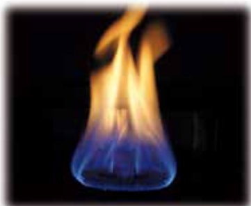
ガス機器とガスの種類が合っていない場合(一例) 不完全燃焼
