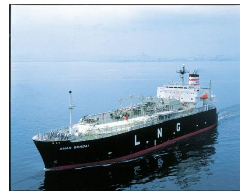
↑ LNGタンカー「アマンセンダイ」 積載容量：18,800m 3 （約8,200 t）
